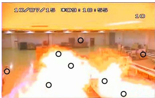
図 5-4 CCTV 画像と計算によって得られた温度コンター図 注)○印は従業員が居た場所を加工して表示
